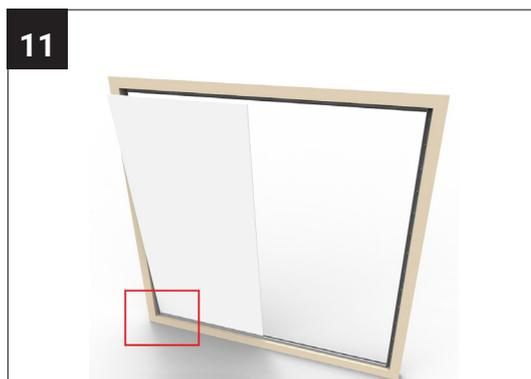
Setzen Sie das Glas leicht geneigt ins Fußbodenprofil und drücken es an, damit es gerade steht.
