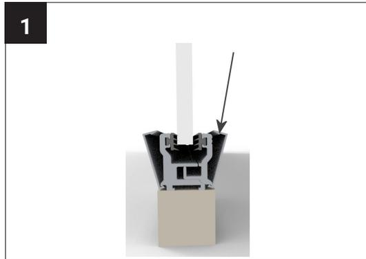
Klipsen Sie die Blende ab, die über der Verschraubung sitzt.
